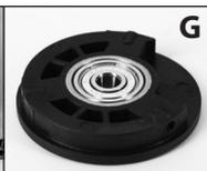
3. Coloque el terminador con el lado externo hacia abajo sobre un bloque de madera. Place the new 5x16x5mm bearing in the end bell housing. Coloque el rodamiento de 6 x 17 x 6 mm nuevo en la estructura del terminador. Coloque otro bloque de madera en la parte superior del rodamiento y golpee el rodamiento en el terminador con un mazo de plástico (F). Asegúrese de que el terminador esté completamente asentado (G).
