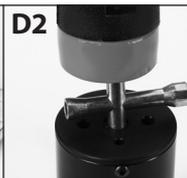
2. Coloque uno de los rodamientos incluidos en la lata del motor. Colóquelo sobre el refuerzo del rodamiento empotrado dentro de la lata. Coloque la punta de un destornillador Phillips más grande en el centro del rodamiento y trabaje hasta que el rodamiento esté bien colocado en la lata del motor (E). Use un mazo para dar golpecitos en el rodamiento en la parte restante hacia la lata.
